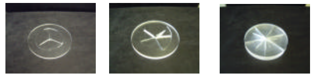
(b) 周辺固定支持の破壊例 冷却したメタクリル樹脂製円板の破壊写真
