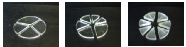
(a) 周辺単純支持の破壊例
