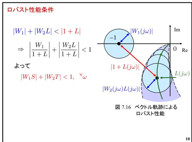
フィードバック制御系のロバスト性解析
