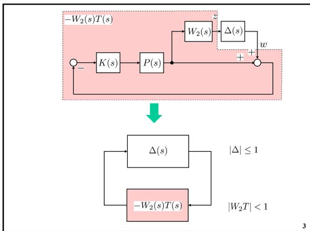
7 フィードバック制御系のロバスト性解析
