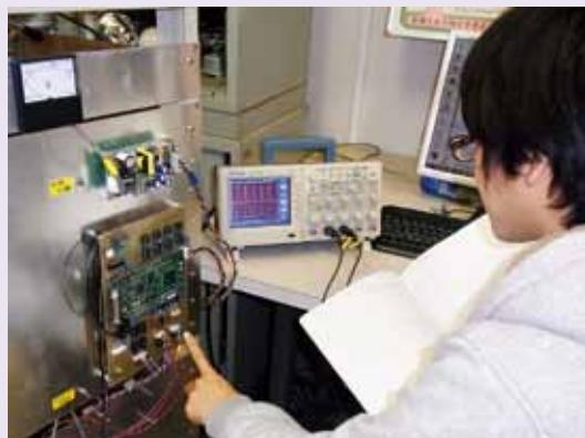
ACサーボモータの制御実験
