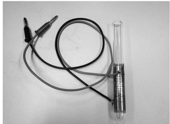
図3 試験管を利用した恒温槽の外観
