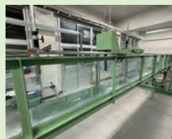
水理実験システム(開水路流れ実験システム)
