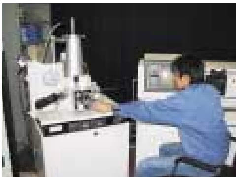
走査電子顕微鏡によるガスケット密封面の表面観察
